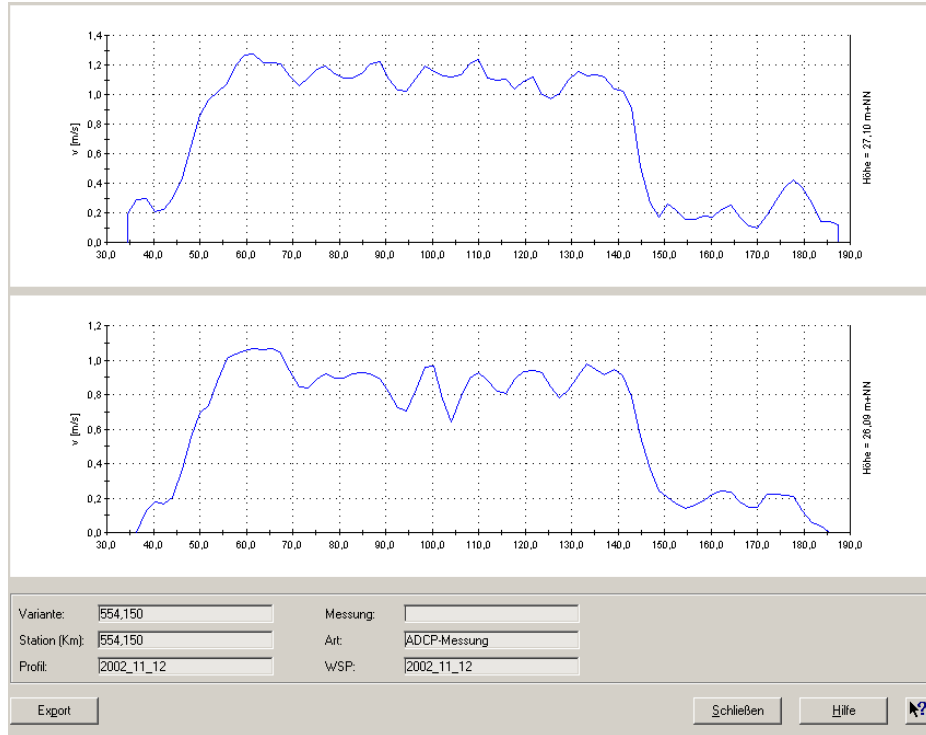
Bild 7: Horizontale Geschwindigkeitsverteilung in beliebiger Höhe im Querschnitt, zum Beispiel zur Ermittlung der mittleren Geschwindigkeit im Messpfad einer Ultraschall-Durchflussmessanlage
